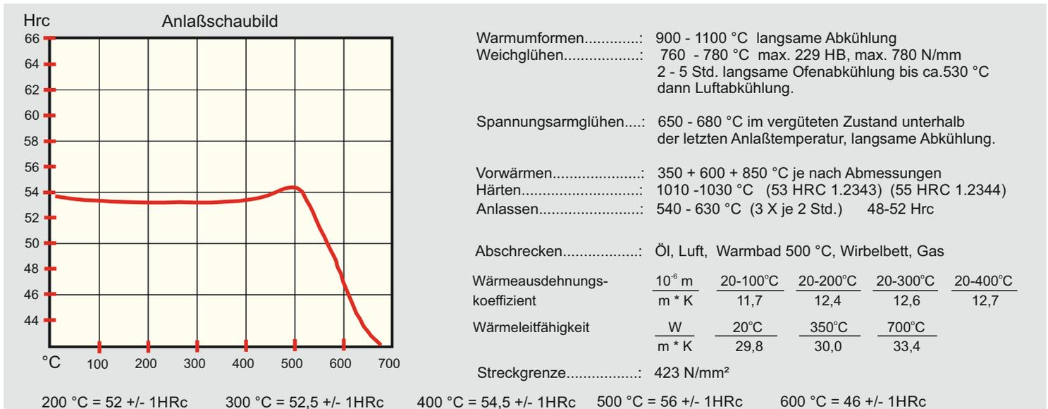
**Anwärmen** Den Stahl in Härteschutzfolie geschützt erhitzen. Es können auch Härtekästen, gefüllt mit neutraler Glühkohle genutzt werden.
