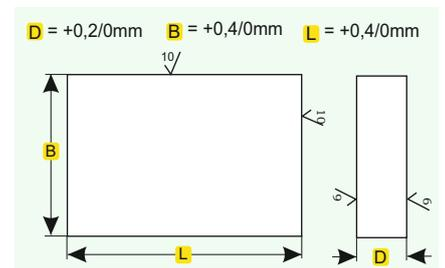
**UNIVERSALPLATTEN sind rundum gefräst und in der Dicke feinstgefräst oder vorgeschliffen.**
