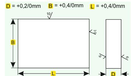
**UNIVERSALPLATTEN sind rundum gefräst und in der Dicke feinstgefräst oder vorgeschliffen.**
